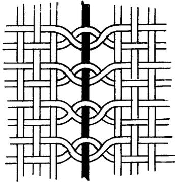
FIG. 1. THE SIMPLEST FORM OF FILLING LENO
