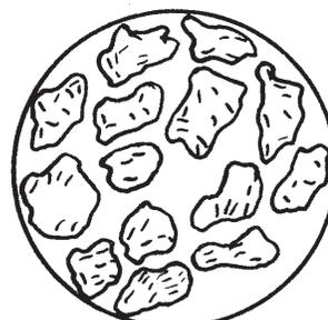
d. Querschnitt des Viscoseseide-Fadens
