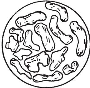
a. Querschnitt des Nitrosilke-Fadens
