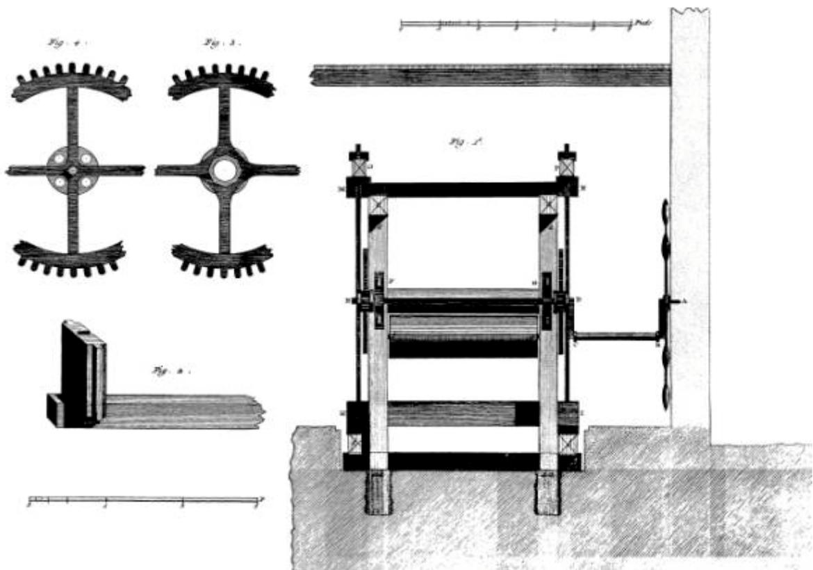
*Soierie, Élévation antérieure de la Machine servant à Cylindre les Étoffes et Développement de quelques toises de so. Paris.*
