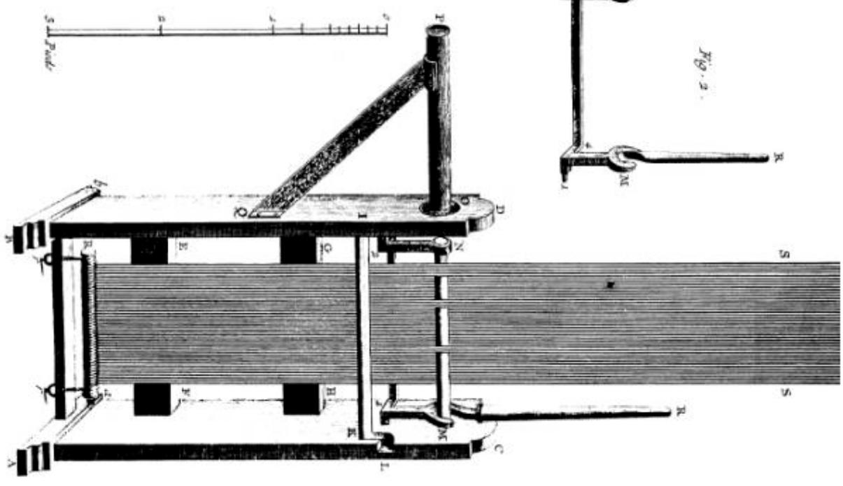
Soierie, construction de la Machine pour la Tye
