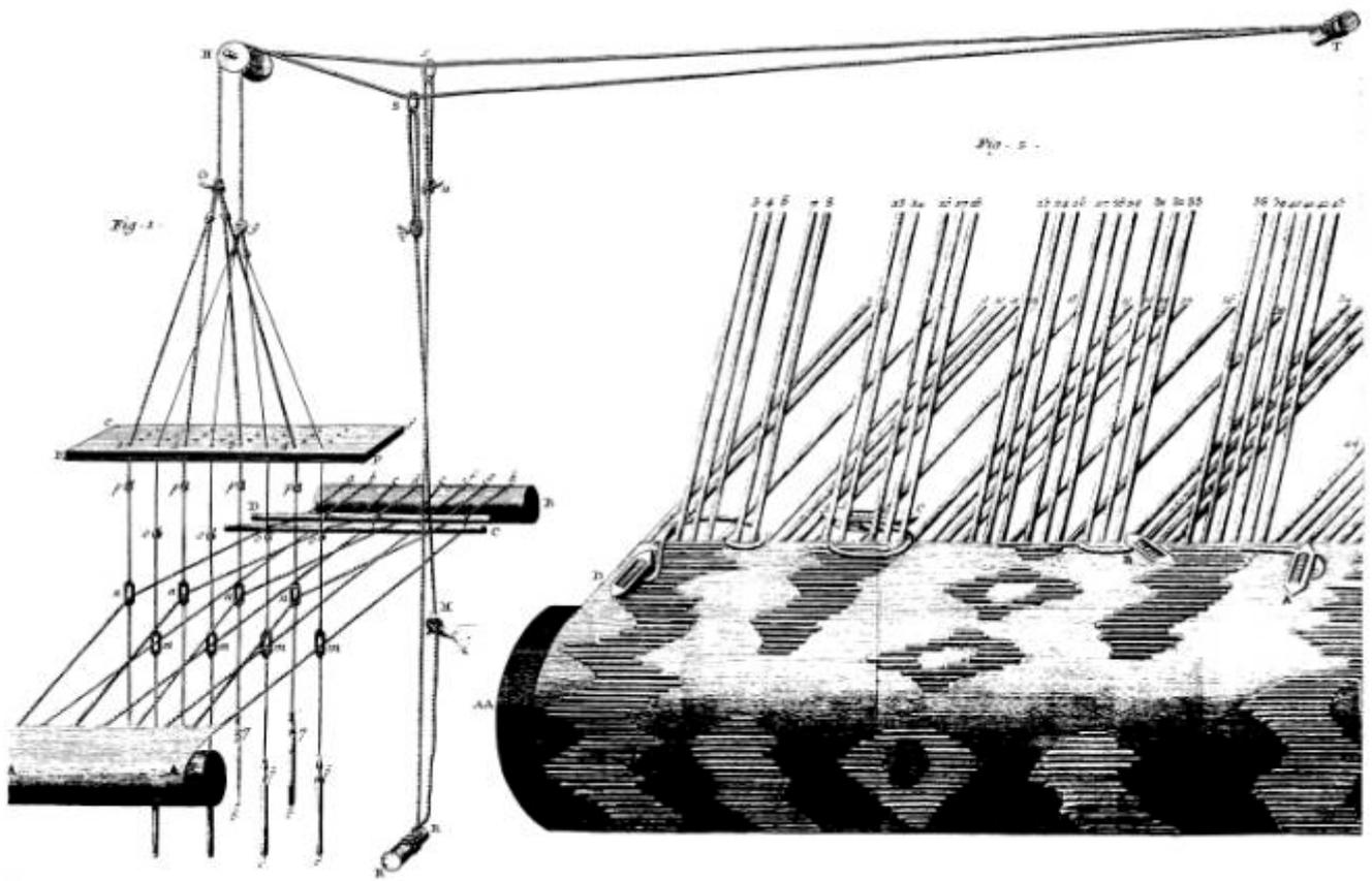
*Soierie, Développement des Cordes de Rame et de Sample et leur action sur les Fils de la chaîne des Étoffes Brochées ou le Poil des Velours frisés et Coupés. Partie d'Étoffe Brochée Vue du côté de l'envers et au Microscope.*
