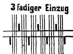
die Skizzen Fig. 2196 a und b wird ein 2 fadiger und ein 3 fadiger Einzug bei einem Doppelwebeblatt veranschaulicht.
