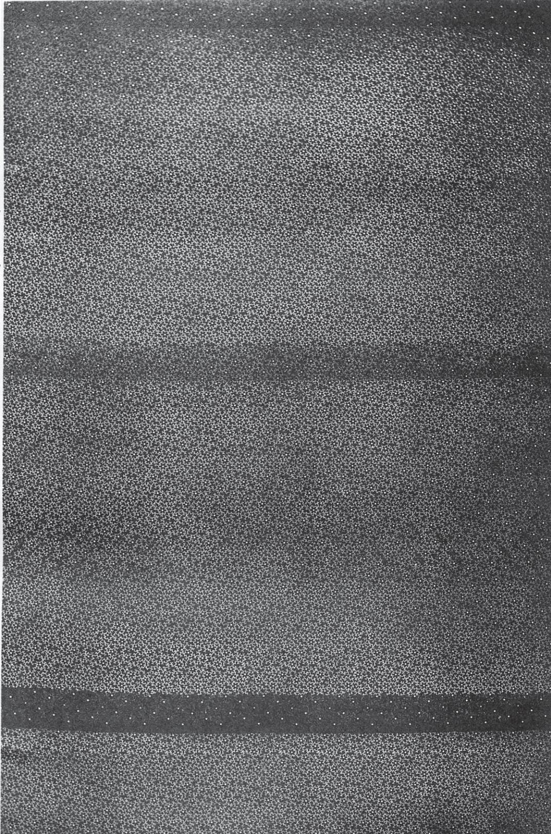
**Absteller (Fehlstelle im Gewebedruck, hervorgerufen durch Stillstand der Druckmaschine).**
