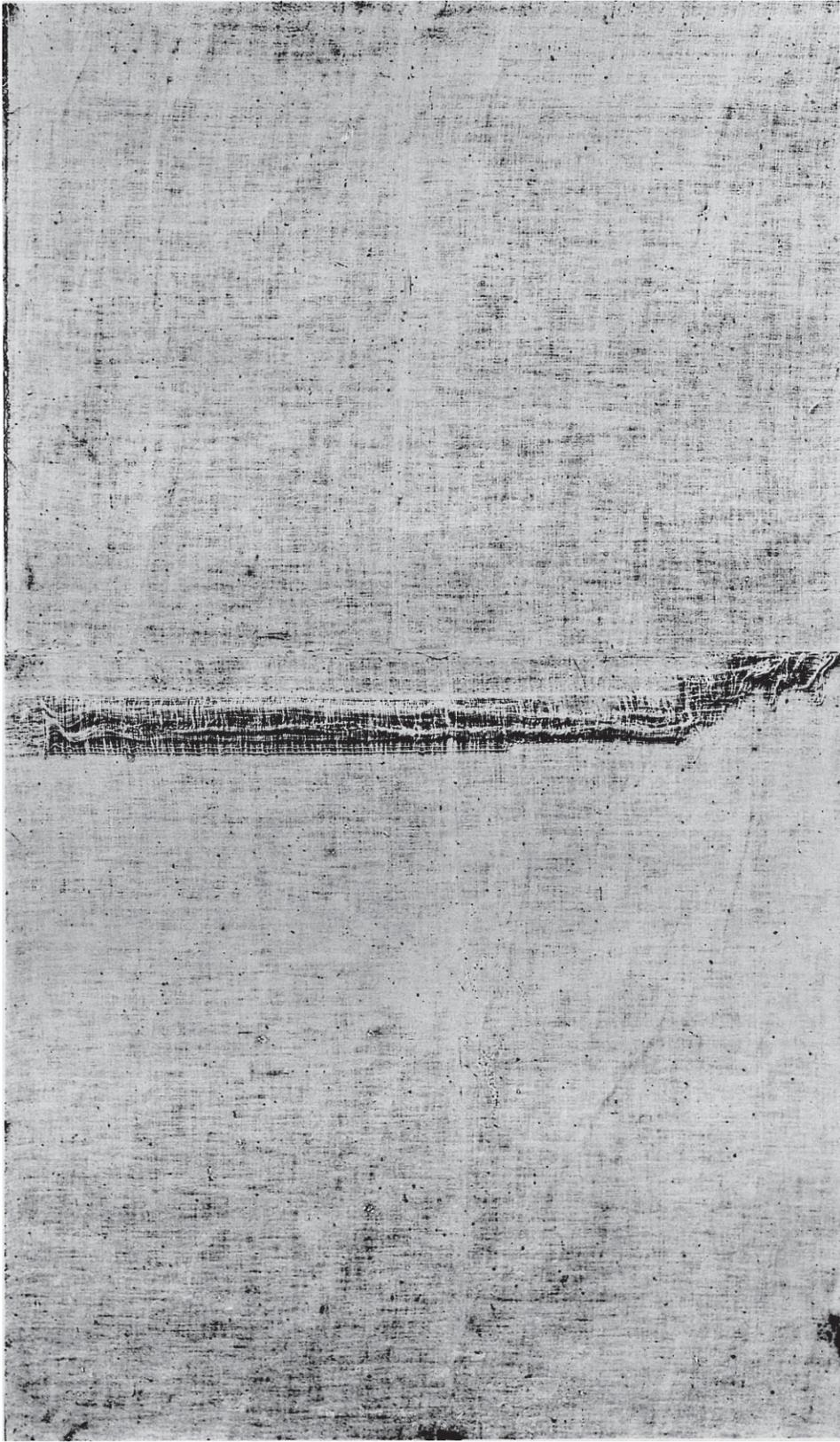
**Nester im Gewebe (hervorgeufen durch Kettfadenbruch).**
