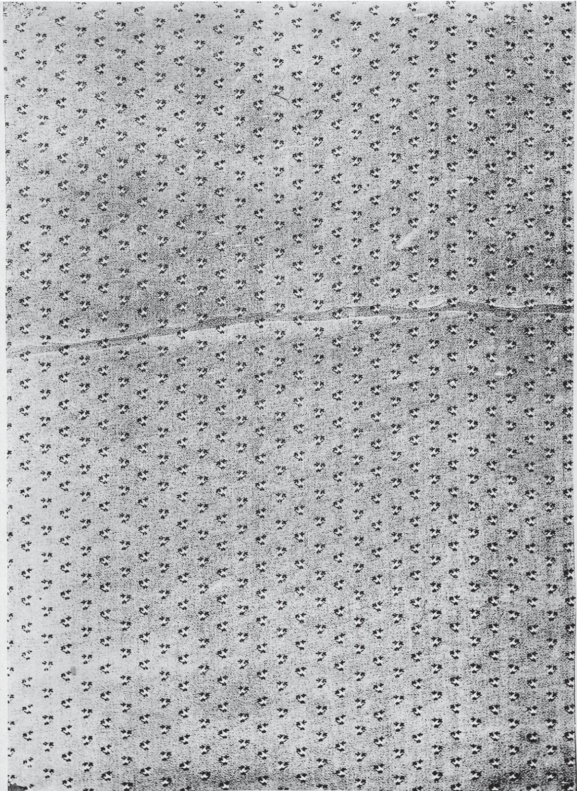
**Fehlstelle im Gewebedruck, hervorgerufen durch Mitläufernaht.**
