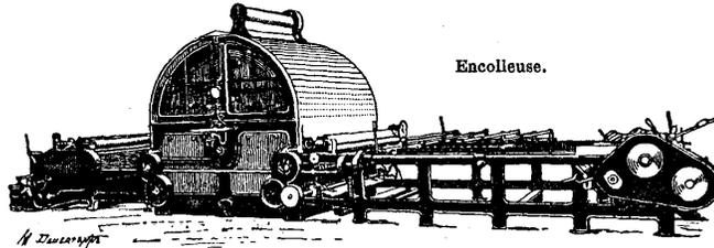
les divers organes ci-dessus subsistent ; on leur ajoute une chambre de séchage, formée d'un certain nombre de compartiments dans lesquels les fils de la chaîne à sécher circulent, tout en étant continuellement en contact avec un courant d'air chaud.
