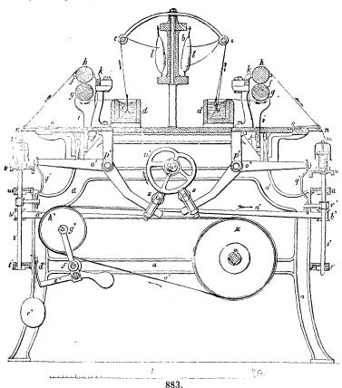
cylindres h, que de broches, et que ces cylindres sont mus par la friction des cylindres inférieurs.
